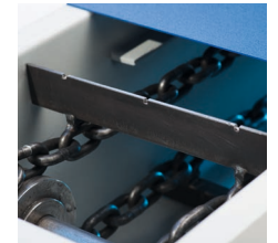
Боковое уплотнение Lateral seal
