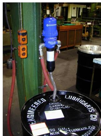
В сфере приготовления смазочно-охлаждающих жидкостей наиболее популярными и подходящими моделями являются модели дозаторов **DI110**, **D3RE10**, **D45RE8**. Технические характеристики данных дозаторов приведены в таблице.
